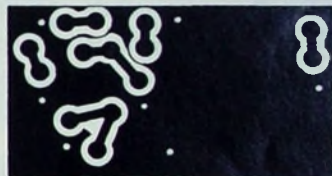
Bild 4. Gedruckte Schaltung der Spulenplatte (Maßstab 1:1)
